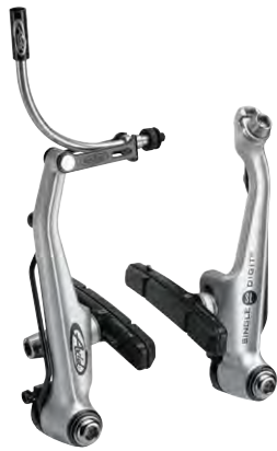
195210 AVID KOČNICA KOMPLET V BRAKE SD SL Hladno kovane ručice klješta, aluminijumska centralna konzola, linearne opruge, pakne sa promenljivim ulošcima, titanijumski sitni delovi.
